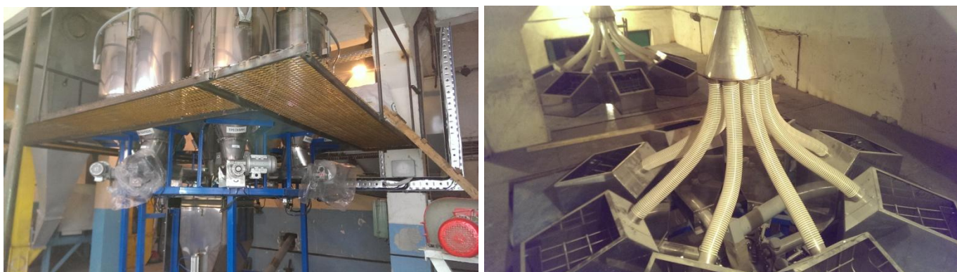
Фото 1. Линия микродобавок на 25 компонентов со специализированной аспирацией.
