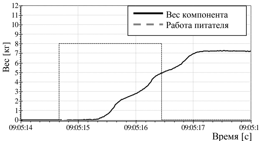
Рис. 4 Процесс загрузки дозатора
